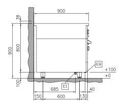
Electrical inlet (power) Equipotential screw
